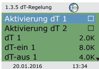
Wurden unter »1.3.7 Ausgangsparameter« Regelungsalgorithmen mit »dT« festgelegt, können die entsprechenden Ausgänge hier konfiguriert werden.
