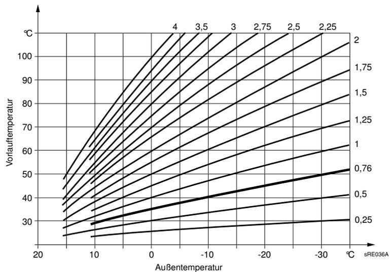
**Beispiel:** Die Steilheit der Heizkennlinie ist auf „0,76“ eingestellt. Außentemperatur beträgt 0°C:
