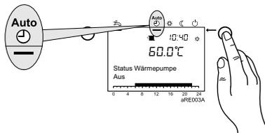
Mit der Betriebsarttaste Heizbetrieb wird zwischen den Betriebsarten für den Heizbetrieb gewechselt. Die gewählte Einstellung wird durch einen Balken unterhalb des Betriebsart-Symbols gekennzeichnet.
