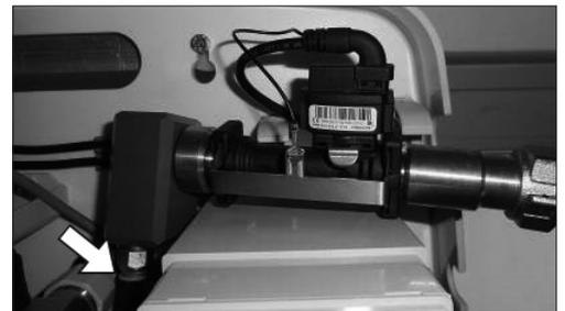
4. Massebrücke auf der Mischblockseite herausziehen und Mischblock von der Baugruppe Drucksensor abziehen.
