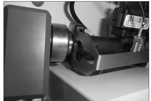
5. Drucksensorkabel und Massekabel abziehen.
