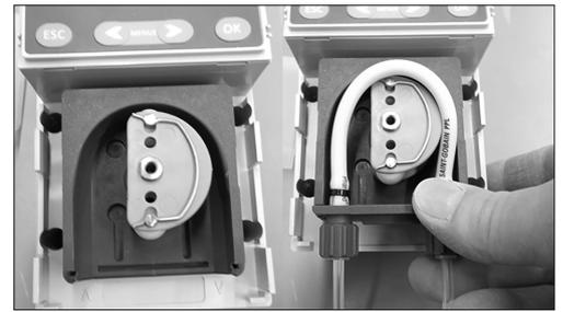
2. Die Halterung links und rechts an der Überwurfverschraubung des Saug- und Druckschlauchs muss vorsichtig so weit eingedrückt oder eingeklopft werden bis das Dosierschlauchset gerade eingesetzt ist.
