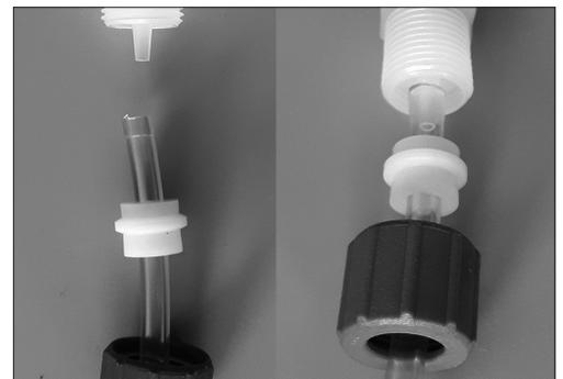
6. Druckbuchse anstecken und blaue Überwurfverschraubung festdrehen.
