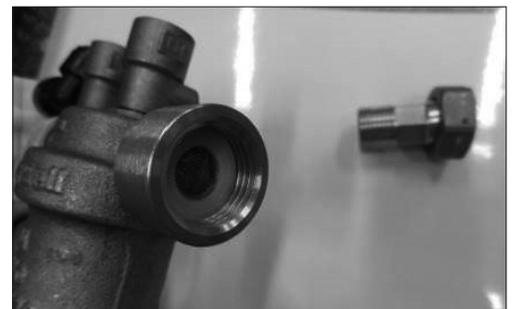
5. Die halbe Muffe abschrauben, das innen liegende Sieb entnehmen und reinigen oder ggfs. austauschen.
