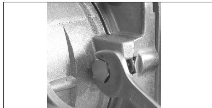
Abb. 4.7: Schnellverschluss 90° gedreht - geschlossen
