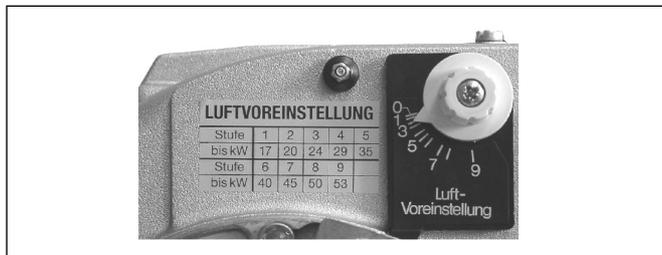
Abb. 4.13: Luftklappeneinstellung
